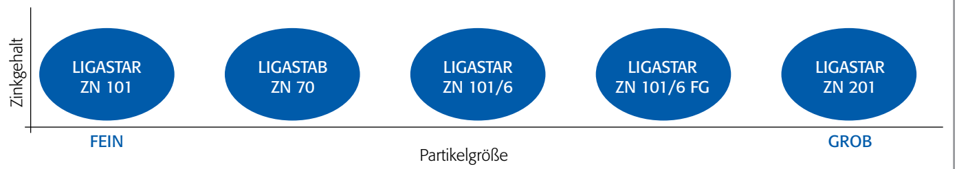
Abb. 5: Korngrößen verschiedener Zinkstearat-Qualitäten
