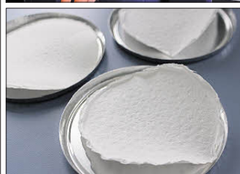
Exakt 170 Gramm Zeitungsschnipsel benötigt Franziska Günther für einen Versuch. Wilhelm Huber, der Leiter der Entwicklung in der Firma Peter Greven, war froh über den Stapel Rundschau-Ausgaben. In der Deinkingzelle werden die Fasern mit Wasser, Seife und anderen Mitteln kräftig gemixt. Mit den Plättchen (r. u.) kann am Ende der Weißegrad des fertigen Papiers im Labor bestimmt werden. (Fotos: Röder)
