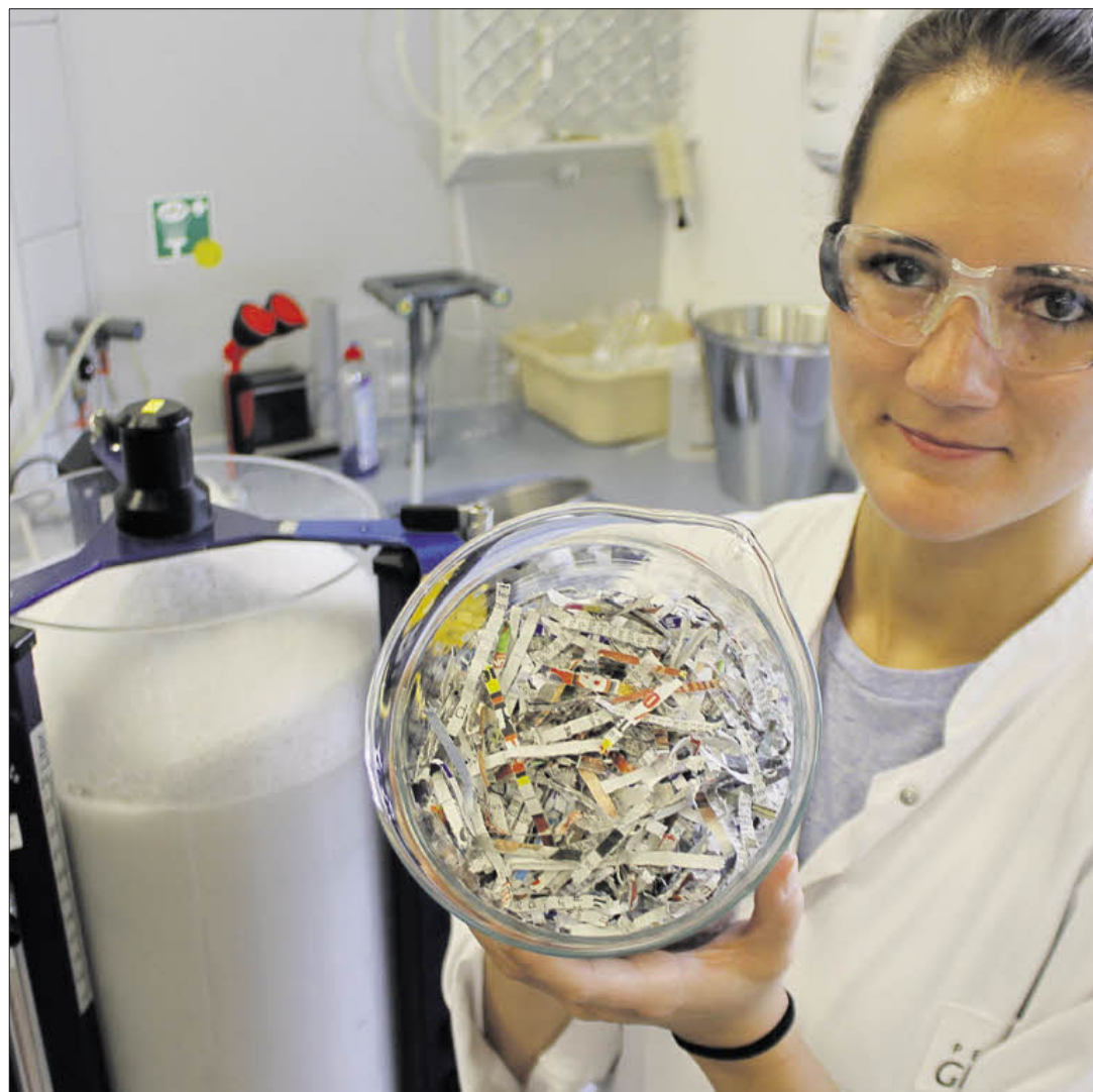
Exakt 170 Gramm Zeitungsschnipsel benötigt Franziska Günther für einen Versuch. Wilhelm Huber, der Leiter der Entwicklung in der Firma Peter Greven, war froh über den Stapel Rundschau-Ausgaben. In der Deinkingzelle werden die Fasern mit Wasser, Seife und anderen Mitteln kräftig gemixt. Mit den Plättchen (r. u.) kann am Ende der Weißegrad des fertigen Papiers im Labor bestimmt werden. (Fotos: Röder)
